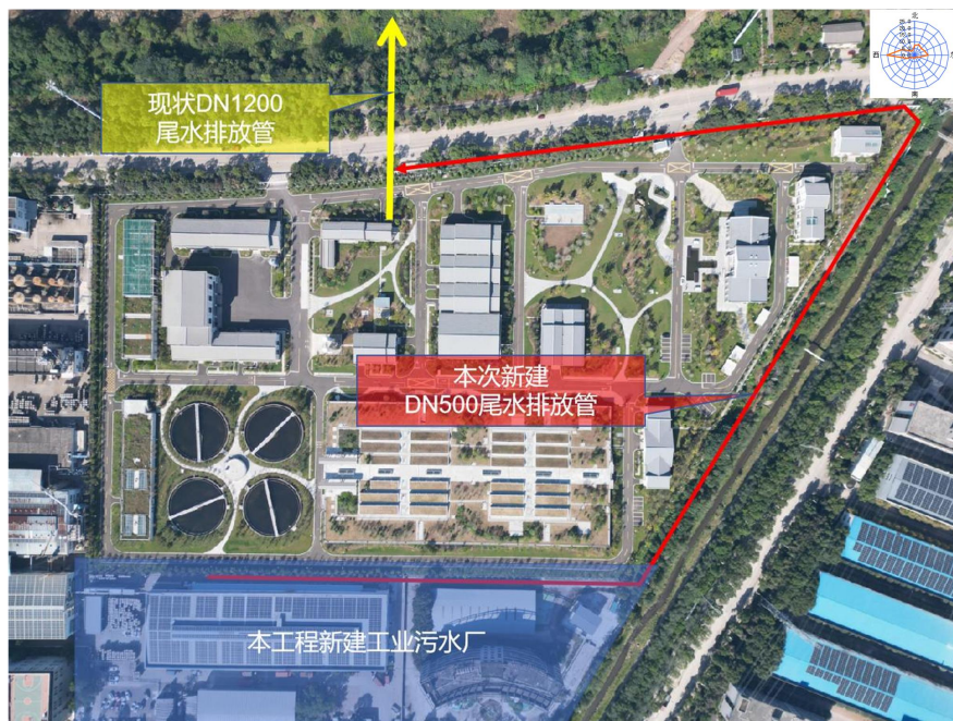
图 3.3.1-6 尾水管道线路图
