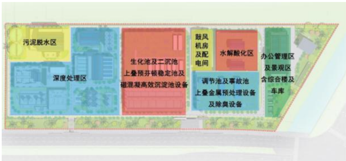
图 3.2.6-1 工业污水处理厂建筑总平面图
