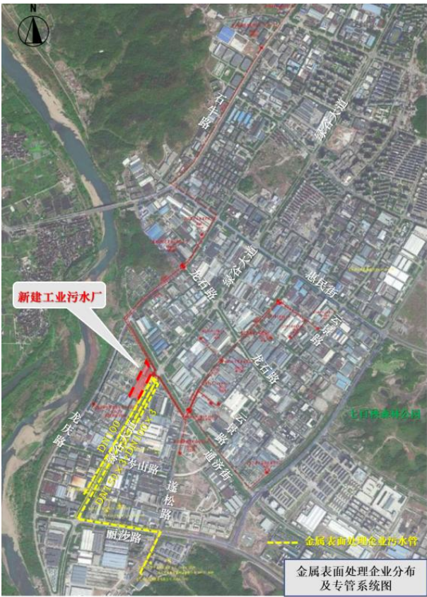
图 3.3.1-5 金属表面处理行业分区管线系统图
