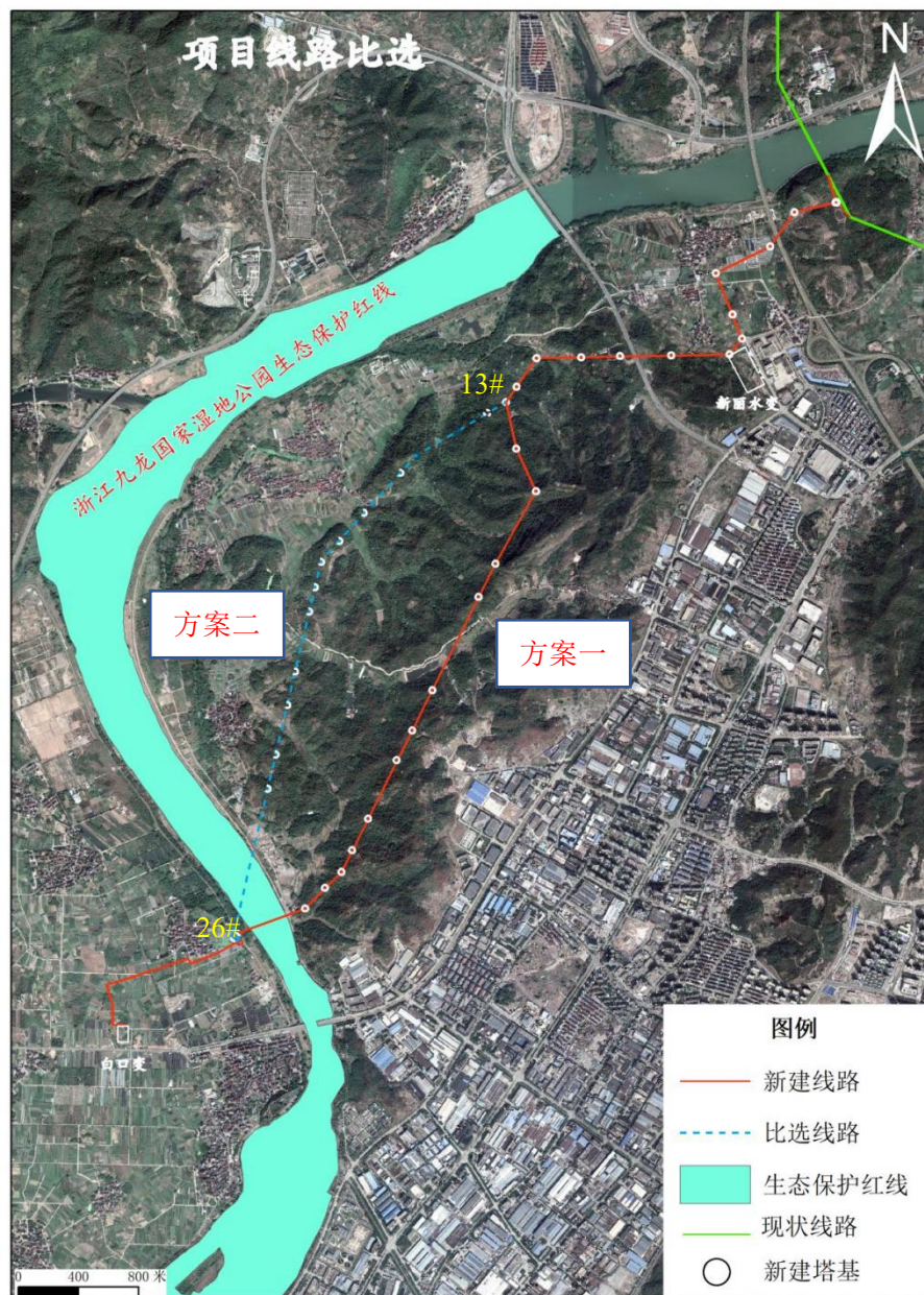
图 4-5 项目线路方案比选示意图
