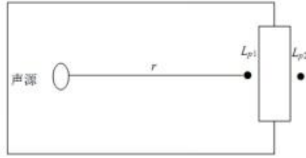
图 5.2.21 室内声源等效为室外声源图例
