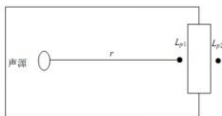
图 5.2.8 室内声源等效为室外声源图例
