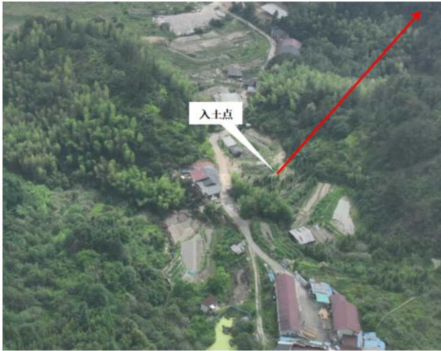
图 4.1- 5 坝头山体定向钻入土点位置示意图
